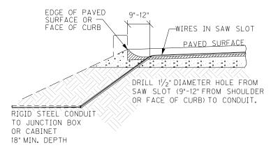
SAW SLOT EDGE OF PAVEMENT TRANSITION
